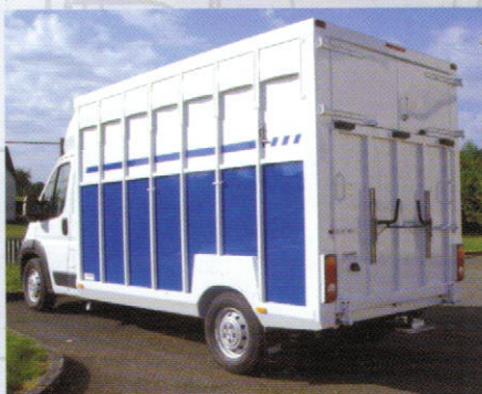
- Version standard - Aération par volets coulissants
