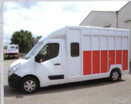
- Version standard - Aération par volets coulissants
